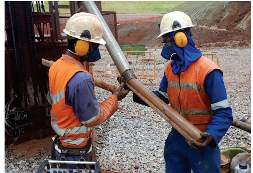
Figura 3 – Retirada de amostra de solo do barrilete sônico. A amostra sai por meio da vibração do barrilete pelo operador, até uma calha, e após é acondicionada na forma adequada.
